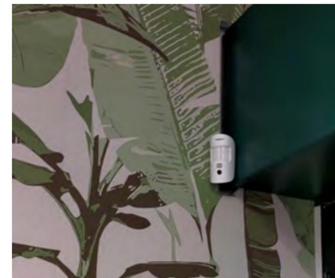
Sopra: Sensore volumetrico con fotocamera integrata, quando il dispositivo rileva infrazione scatta da 3 a 10 fotogrammi per immortalare il soggetto
